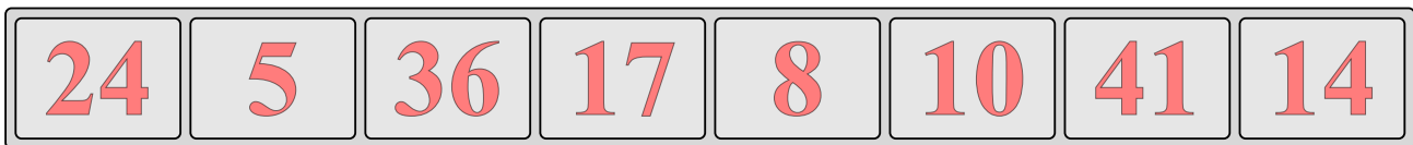
Рис. 1. Пример неупорядоченного массива; красным цветом представлены хранимые ключи; для компактности значения не представлены.
