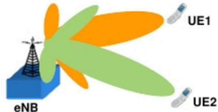
MU-MIMO в линии DL на основе формирования узконаправленных излучений (Beamforming)
