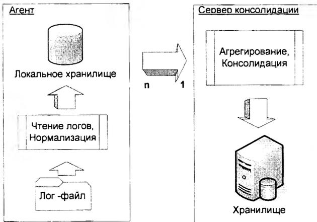
**Рис. 2. Схема системы консолидации логов.**
