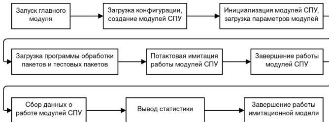
Рис. 2: Схема работы имитационной модели.
