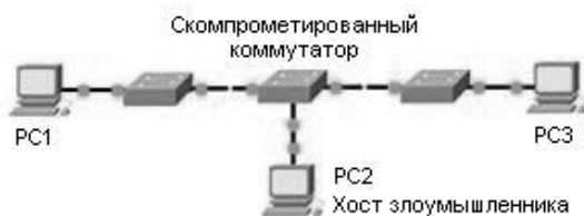
Рисунок 3. Сценарий 1 – непосредственное подключение к коммутатору
