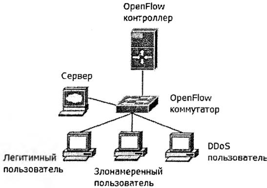
Рис. 1. Логическая схема экспериментального стенда
